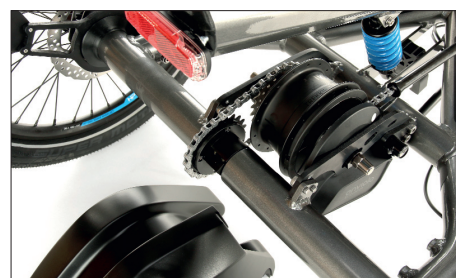
Blick unter die Haube: die Antriebstechnik im Heck des Delta tx.
