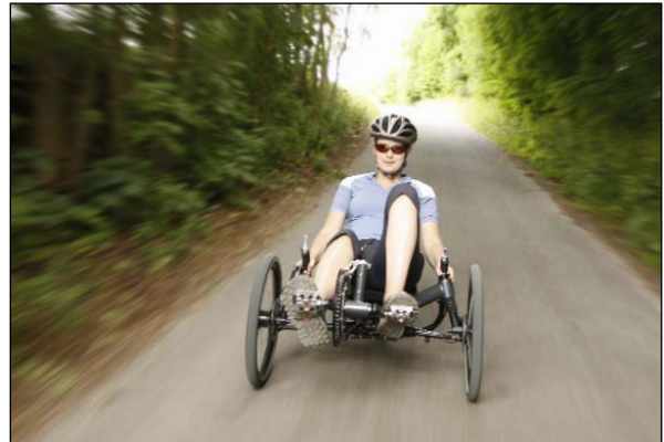
Neueste Entwicklung von HP Velotechnik für 2009: Das voll gefederte und faltbare Tourenreirad Scorpion fs.
