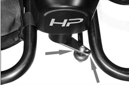
Abb. 13: Zur Befestigung der Schubstange und Einstellung der Lenkung stehen 2 Gewinde am Lenkhebel zur Auswahl.
