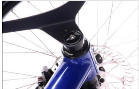
Steuerkopflager mit Abdeckkappe und montiertem Schutzblech
