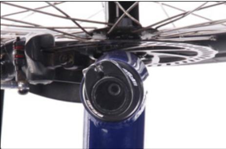
Steuerkopflager mit Kralle im Inneren des Steuerrohrs
