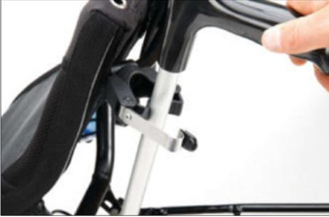
Die Gehhilfe hält nun bereits in der Halterung. Das Sicherungsblech klappt selbsttätig vor. Drücken Sie es über das Gummitteil, so dass es über den äußeren Teil der Halterung rutscht und fühlbar „einrastet“. Nur dann ist die Gehhilfe gegen unbeabsichtigtes Herausfallen gesichert.
