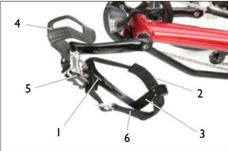
Fersenbandplatte (1), Fersenbandschlauch (2), Fersenbandhaken (3), Pedalkäfig (4), Pedal (5) und Fersenbandriemen (6)
