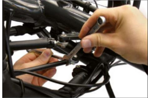
Außen am Radträger wird der Gelenkkopf unter das Halteblech geschraubt. Zwischen Radträger und Gelenkkopf befindet sich zusätzlich zur Unterlegscheibe eine Distanzbuchse. Zwischen Gelenkkopf und Mutter befindet sich ebenfalls eine Distanzbuchse.
