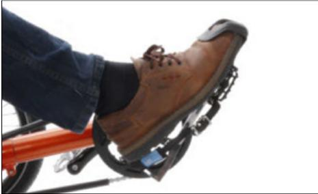
Sobald sich der Schuh ganz vorn im Pedalkäfig befindet, üben Sie einen leichten Druck auf das Pedal aus.
