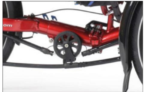
Kettenleitrolle und Kettenschutzrohr am Gekko fxs
