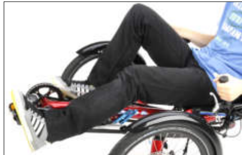
Der Tretlagerausleger wird so eingestellt, dass das Knie beim Fahren gerade nicht maximal durchgestreckt wird.
