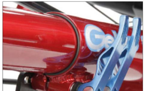
*Zwischen dem Hauptrahmen und dem Tretlagerausleger muss die Distanzbuchse sichtbar sein.*
