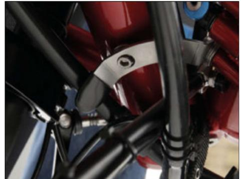
**⚠Achtung!** Achten Sie darauf, dass das Faltsicherungsblech beim Schließen nicht durch Kettenschutzrohr oder Bremszüge behindert wird.
