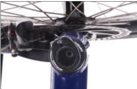
Steuerkopflager mit Kralle im Inneren des Steuerrohrs
