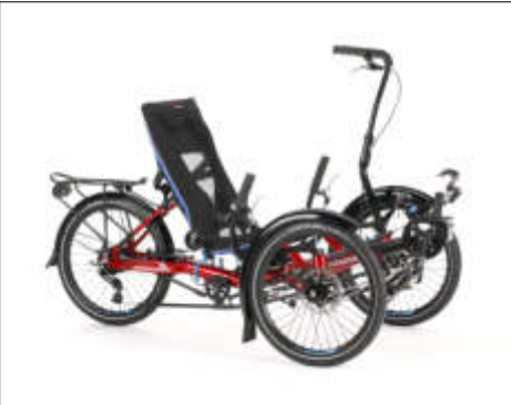
Der stabile Begleitergriff am Gekko fxs ermöglicht Mitlenken, Beschleunigen und aktives Bremsen
