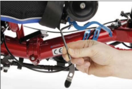
2. Mit der rechten Hand unter dem Rahmen an die Lasche des Faltsicherungsbleches greifen und dieses nach unten drücken. Mit der linken Hand den Hinterbau greifen.
