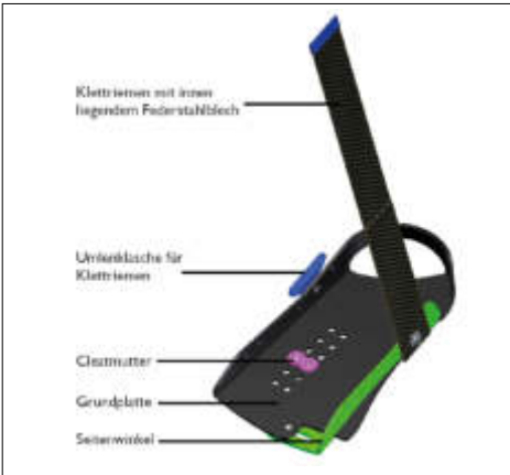
Teilebezeichnung am Beispiel eines Ergo-Sicherheitspedals
