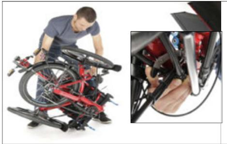
9. Der Aufstellwinkel des gefalteten Rades lässt sich über die Anschlagsschraube der Sitzflächenschnellspanner justieren.
