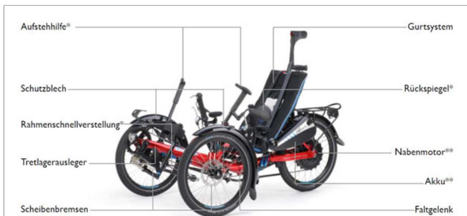
Das Gekko fxs mit detaillierter Übersicht der Komponenten.
