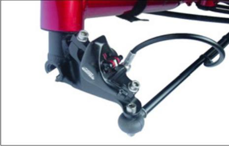
*RICHTIG: Die Hydraulikleitung soll so montiert werden, dass sie den Bremssattel in einem weiten Bogen nach schräg oben verlässt.*
