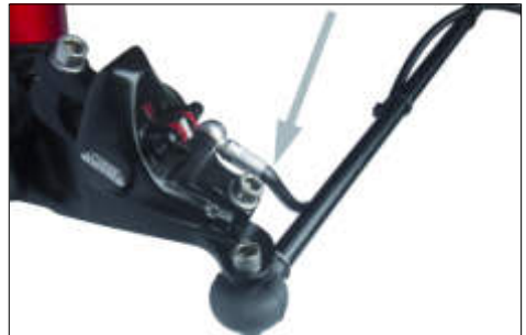
FALSCH: Der Bogen der Hydraulikleitung liegt unter der Spurstange: Gefahr des Abknickens der Leitung (Pfeil).
