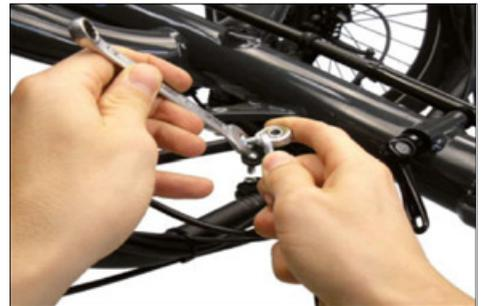
Drehen Sie den Gelenkkopf in die Spurstange hinein, um den vorderen Abstand  $b_v$  zwischen den Vorderrädern zu vergrößern, drehen Sie den Gelenkkopf hinaus, um den Abstand zu verkleinern.
