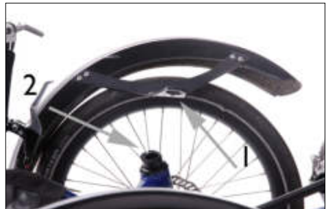
Madenschraube (1) und Klemmschlitz (2) bei der Schutzblechmontage
