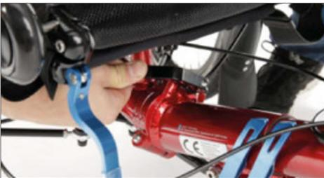
6. Den Klettgurt der Rückenlehne unter dem Querträger lösen und am Sitz befestigen.
