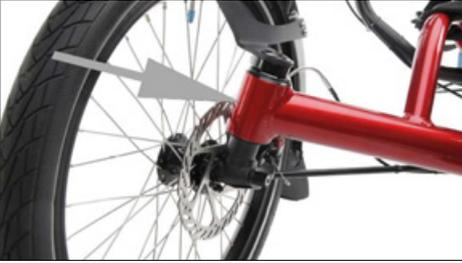
Die Rahmennummer befindet sich am Steuerrohr beim rechten Vorderrad, für die Radcodierung kann das Steuerrohr beim linken Vorderrad verwendet werden.
