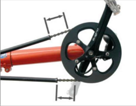
Zwischen den Enden der Kettenschutzrohre und den Schaltungsteilen müssen bei gespannter Kette mindestens 5 cm Abstand verbleiben
