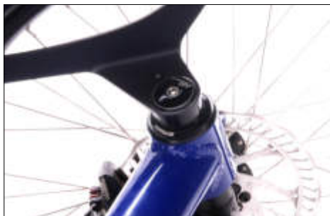
Steuerkopflager mit Abdeckkappe und montiertem Schutzblech
