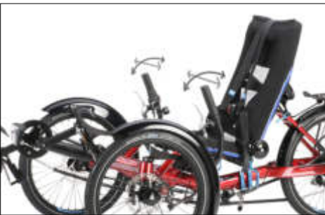
Der Lenker lässt sich in der Breite (1) und in der Neigung (2) verstellen
