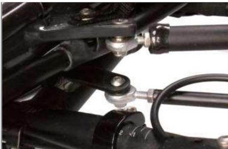
Befestigen Sie den Gelenkkopf am Lenkervorbau. Schieben Sie dazu zuerst die Unterlegscheibe und danach den Gelenkkopf von unten auf die Schraube, die in der Bohrung des Halteblechs am Lenkervorbau steckt.
