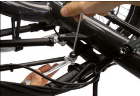
Halten Sie den Gelenkkopf mit einem Gabelschlüssel oder einer Zange am Gehäuse und lösen Sie die Kontermutter, die gegen die Spurstange geschraubt ist.
