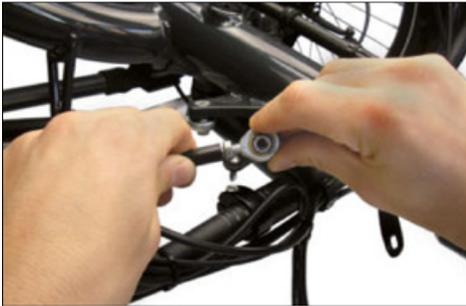
Richten Sie beide Kugelhöpfe parallel aus. Halten Sie den Gelenkkopf mit Gabelschlüssel oder Zange und ziehen Sie die Kontermutter mit 4–5 Nm gegen die Spurstange fest.
