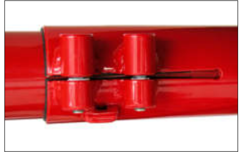
Beim Blick von unten in den Klemmschlitz darf das Ende des Tretlagerauslegers nicht sichtbar sein.
