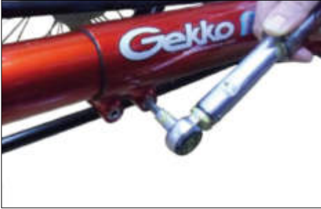
Lösen der Klemmschrauben zum Verstellen des Tretlagerauslegers.
