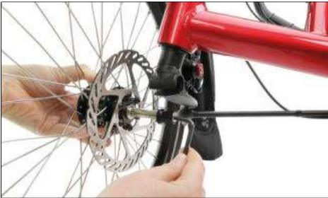
Beim Wiedereinbau die Scheibe sorgfältig zwischen die Bremsbeläge einfädeln, ohne diese zu beschädigen. Ziehen Sie die Schraube im Endstück mit 8 – 10 Nm fest.
