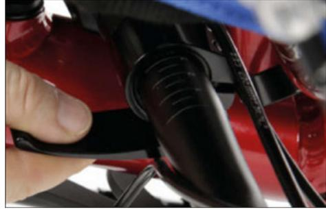
Lenkerklemmschelle mit Schnellspannhebel
