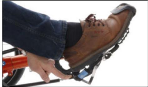
**!Achtung!** Achten Sie darauf, dass der Riemen nicht in Kontakt mit der Kurbel kommt. Falls nötig biegen Sie die Federstahlverstärkung leicht von der Kurbel weg.
