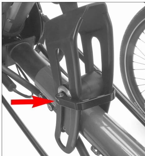
Pour libérer le mât de la position la plus haute, ouvrez le levier de serrage rapide et appuyez dans le sens de la flèche.
