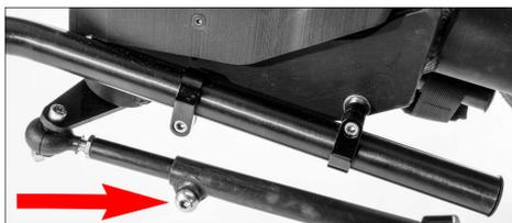
Vis de serrage pour réglage longueur tringle de direction
