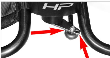
Pour fixer la tringle de commande de direction et pour le réglage de la direction, il y a le choix entre deux perçages sur la biellette.
