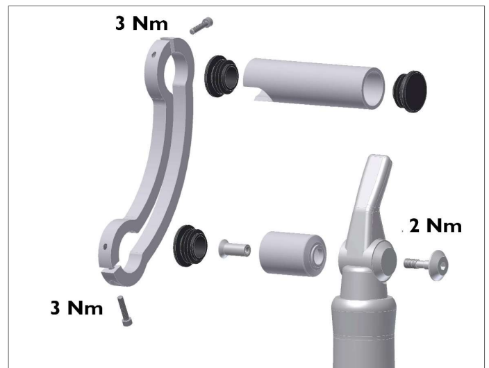
Abb. 3: Montage am Lenkerendschalthebel MICROSHIFT BS 09 oder STURMEY ARCHER HSJ 963. Der Adapter wird mit der vorhandenen Gewindehülse am Lenkerendschalthebel befestigt.
