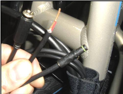
Links: Kabel mit DC-Buchse für Rekuperationsaktivierung;
