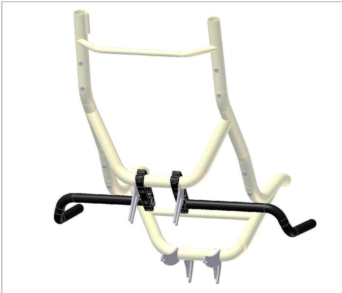
Abb. 5: Bei ErgoMesh Sitz HS XL: Montage der Klemmen innerhalb der Sitzhalterungen. Die Klemmung kann auch am Rahmen unter der Sitzfläche innerhalb der Sitzhalterungen erfolgen.
