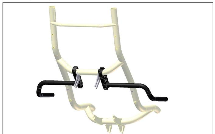
Abb. 3: Montage der Klemmen am Rahmen der Rückenlehne mit Ausrichtung nach unten, die Halterohre zeigen nach vorne und unten.
