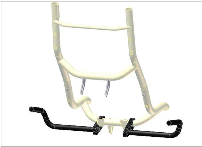
Abb. 4: Montage der Klemmen am Rahmen unter der Sitzfläche mit nach oben und hinten ausgerichteten Halterrohren.
