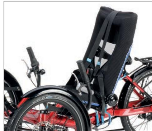
Seriennmäßig wird das Gekko fxs mit einem anpassbaren Gurtsystem am Sitz geliefert. Werden die Gurte nicht mehr gebraucht, können sie einfach abgenommen werden.
