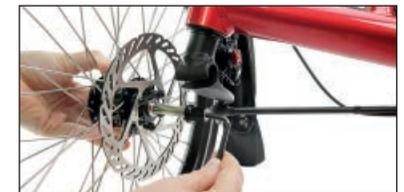
*Praktisch beim Transport: HP VELOTECHNIK hat offene Radträger entwickelt, mit denen die Vorderräder mitsamt den Bremsscheiben nach dem Lösen nur einer Schraube einfach abgenommen werden können, ohne dass die Bremsanlage danach neu justiert werden muss. (Serienausstattung)*
