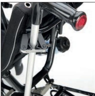
**Der Gehhilfenhalter** ermöglicht einfaches Einsetzen, sicheres Mitführen und schnelle Entnahme von Gehhilfen. Die praktische Schnellaufnahme passt sich stufenlos auf Durchmesser von 20 bis 30 mm an, HP VELOTECHNIKS Fixierung aus Federstahl sorgt für sicheren Halt und gibt die Gehhilfe dank Einhandbedienung schnell und ohne lästiges Hantieren frei. Wahlweise für eine oder für zwei Gehhilfen.
