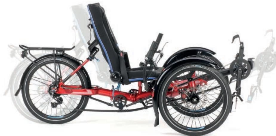
*Dank der intelligenten Rahmen- und Sitzkonstruktion passt sich das Gekko fxs auch unterschiedlichen Körperproportionen stufenlos an. Die Lenkergriffe sind in zwei Längen erhältlich und unabhängig voneinander breiten- und winkelverstellbar. Bemerkenswert: Das Gekko fxs ist mit 137–175 cm Länge deutlich kompakter als viele andere Liegedreiräder!*
