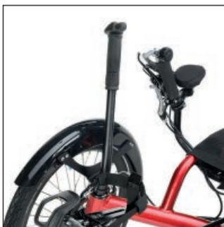
**Mit der Aufstehhilfe** erhalten Sie zwei Handgriffe, die jeweils links und rechts über den Vorderrädern montiert werden. Diese bieten festen Halt, um sich aus dem Sitz hoch zu ziehen oder um sich beim Einsteigen abzustützen. Die Aufstehhilfen können mit einem Schnellspanner einfach eingestellt oder zum Transport abgenommen werden.
