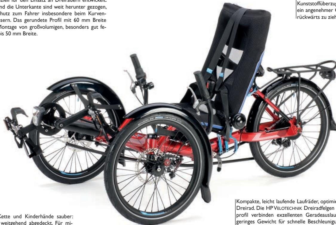
**Kompakte, leicht laufende Laufräder,** optimiert für die hohen Seitenkräfte am Dreirad. Die HP VELOTECHNIK Dreiradfelgen mit robustem Aero-Hohlkammerprofil verbinden exzellenten Geradeauslauf, maximale Seitensteifigkeit und geringes Gewicht für schnelle Beschleunigung. Leicht laufende, gut federnde SCHWALBE Tryker Dreirad-Bereifung mit Pannenschutzeinlage. HP VELOTECHNIK Naben mit wartungsfreien Präzisions-Kugellagern. Rostfreie Edelstahlspeichen.
