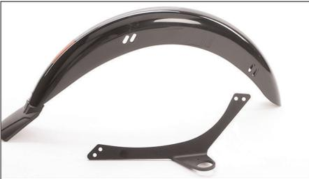
Positionierung des Schutzblechhalters am Schutzblech (linkes Schutzblech)
