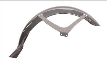
Positionierung des Schutzblechhalters zum Schutzblech (linkes Schutzblech)
