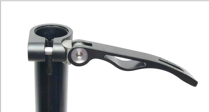
15. Schieben Sie das obere Vorbauteil mit Lenker in das mittlere Vorbauteil ein und schließen Sie den Schnellspanner. Verwenden Sie im Klemmbereich eine reibungserhöhende Montagepaste (z.B. DYNAMIC Carbon Montagepaste).
