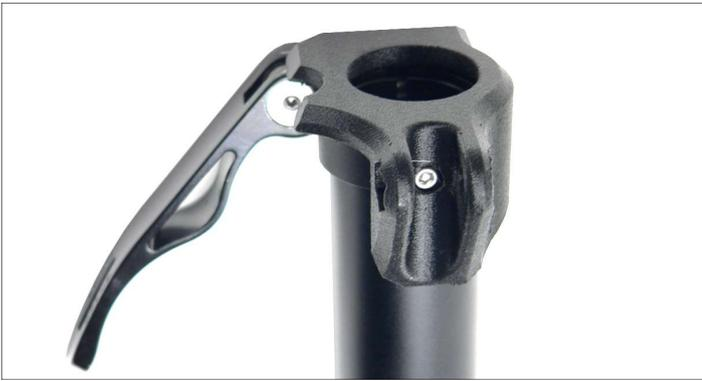
12. Schieben Sie das Vorbaumittelteil wieder in das untere Vorbauteil ein und schließen Sie den Schnellspanner.
