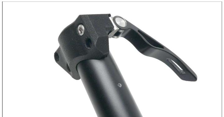
11. Schrauben Sie die M3-Schraube unter Verwendung von Schraubensicherung mittelfest (z.B. Loctite 243) durch den Licht- und Kabelhalter vollständig in die Klemmschelle ein und ziehen Sie sie mit 1 Nm fest. Stellen Sie sicher, dass die Schraube nicht in das untere Vorbauteil hineinsteht, damit das Vorbau-mittelteil beim Einschieben nicht beschädigt wird.
