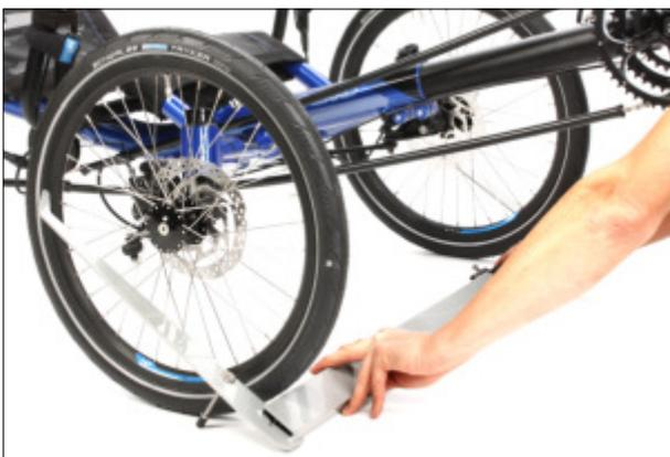
4) Lösen Sie die Rändelschraube an der schwarzen Schiebehülse. Verschieben Sie die Hülse so, dass die Markierung "0" mit der Endkante des linken Vierkantrohres übereinstimmt. Der Absatz an der Skala hilft bei der Positionierung.
