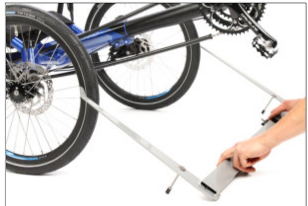
7) Dort, wo die Kante des linken Rohres nun an der Skala steht, kann der Wert für die Spur abgelesen werden.
