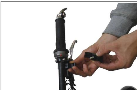
5) Setzen Sie von oben das Rohrstück mit dem Bremshebel in die Klemme ein, richten den Bremshebel und die Klemme nach Ihren Bedürfnissen aus..
