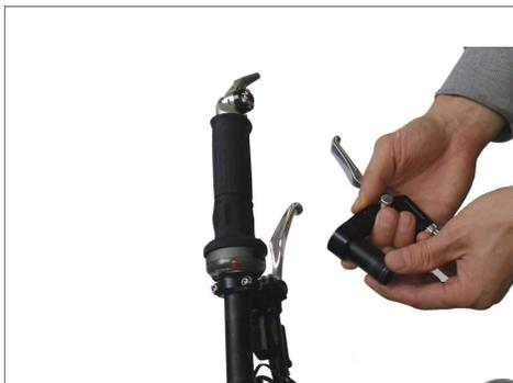
3) Ziehen Sie die Klemmung des Bremshebels gemäß Drehmomentangaben des Bremshebelherstellers an und stecken Sie den Lenkerendstopfen oben in das Rohrstück. 4) Entfernen Sie die Schraube aus beiden Klemmteilen und setzen Sie das Klemmteil mit dem Innengewinde von vorn unter den vorhandenen Bremshebel. Setzen Sie das andere Klemmteil von hinten mit der Schraube dagegen und schrauben Sie die Klemmschraube mit mittelfeaster Schraubensicherung wenige Umdrehungen ein.
