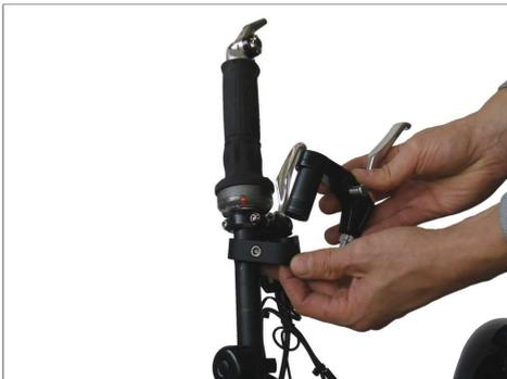
**⚠ Gefahr!** Richten Sie Hebel und Klemme so aus, dass sie die Funktion des vorhandenen Bremshebels nicht stört, die Funktion des zusätzlichen Bremshebels nicht gestört wird und der Lenkeinschlag nicht eingeschränkt ist. Eine nicht einwandfrei funktionsfähige Bremsanlage kann zu schweren Unfällen führen!
