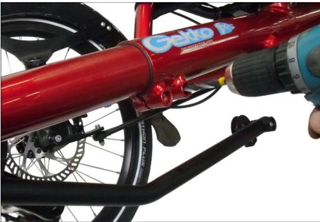
**11)** Schieben Sie die beiden Gewindebuchsen mit dem Innengewinde M6 von links in die Klemmaugen ein. Der in das Gewinde eingeschlagene 5mm-Innensechskant muss nach außen zeigen.
