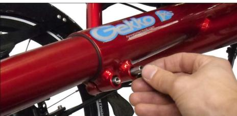
**12)** Montieren Sie von der rechten Seite das Halteblech mit den Linsenkopfschrauben und Unterlegscheiben bzw. Distanzbuchsen unter den Schraubenköpfen. Die Fahne des Haltebleches zeigt nach vorn unten. Schieben Sie das Halteblech so weit nach vorn wie möglich.
