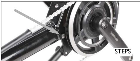
**6)** Ziehen Sie die Schrauben an. Der Bund der Setzmuttern zieht sich in das Material des Haltebleches und verhindert das Mitdrehen der Muttern.
