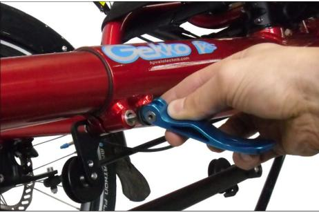
**⚠ Gefahr!** Beide Schnellspanner müssen vor der Fahrt fest geschlossen werden, Schließkraft ca. 15 – 20 kg. Unzureichend geschlossene Schnellspanner führen zum Verdrehen des Auslegers während der Fahrt – Unfallgefahr!
