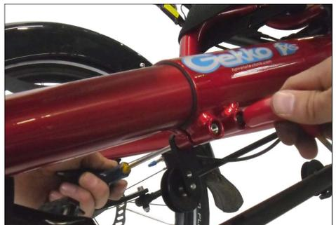
14) Montieren Sie die Buchsen, Federn, Kalotten und Schnellspanner in der Reihenfolge wie im Bild gezeigt.
