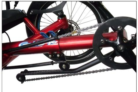
19) Prüfen Sie die feste Verschraubung der beiden Umlenkrollen (Anzugsmoment ca. 6 Nm).
