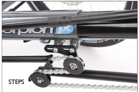
**13)** Ziehen Sie die Linsenkopfschrauben fest, indem Sie mit einem Innensechskantschlüssel 5 mm von der linken Seite gehalten. Anzugsdrehmoment 9 Nm.
