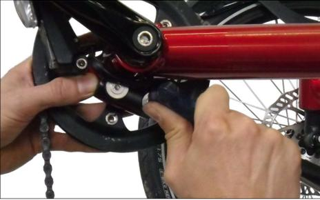
**9)** Entfernen Sie die beiden Klemmschrauben der Tretlagerauslegerklemmung.
