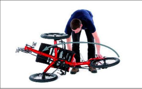
6. Den Gekko fx soweit zusammendrücken, bis das Sicherungsblech hörbar einrastet. (Ist Ihr Gekko sowohl mit dem elektrischen Antriebssystem Shimano STEPS als auch mit einer Rahmenschnellverstellung ausgestattet, lösen Sie die 2 Schnellspannhebel des Auslegers und drehen den Ausleger etwas nach links, um das Einrasten des Sicherungsblechs zu ermöglichen.)
