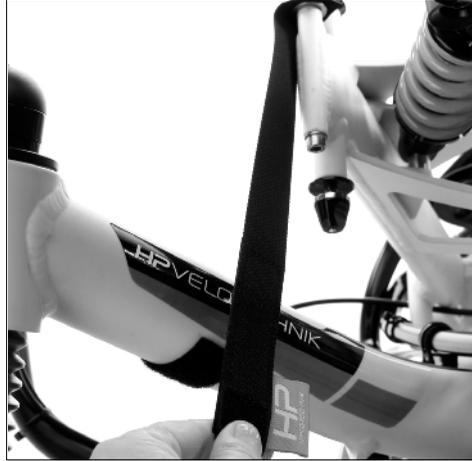
Am Sitzrohr ist ein Klettband befestigt. Legen Sie das Klettband um das Querrohr auf das dort befestigte Klettbandgegenstück. Das Klettband sichert das gefaltete Rad gegen unbeabsichtigtes Auseinanderfallen.
