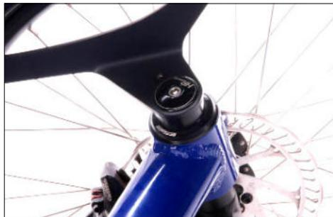
Steuerkopflager mit Abdeckkappe und montiertem Schutzblech
