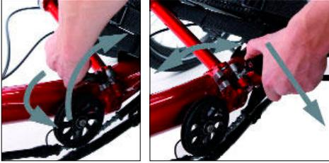
4. Das Hauptrahmenrohr bzw. den Ausleger vor der Oberkante der Rückenlehne mit der rechten Hand umfassen (Knöchel zeigen in Fahrtrichtung rechts) und leicht niederdrücken, damit das Falgelenk nicht wieder einrastet. Die linke Hand umgreift die linke Sitzstrebe von oben, die Knöchel zeigen nach hinten.
