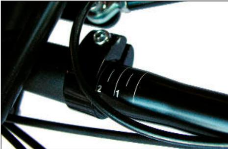
Die Verstellung von Lenkerneigung und -breite erfolgt über die Klemmschellen am Lenkervorbau unter dem Rahmen
