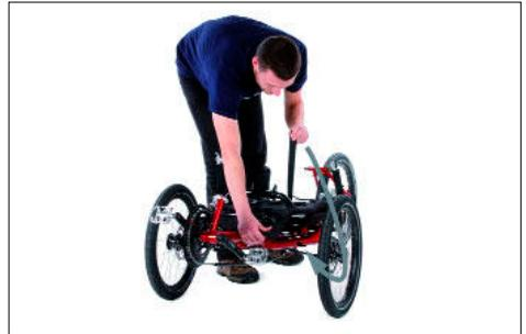
3. Schnellspannhebel am Faltgelenk in der Rahmenmitte öffnen, den Sicherungsbolzen gegen Federdruck entriegeln und Faltgelenk etwas nach oben öffnen. Den Schnellspannhebel soweit nach oben schwenken, bis er in senkrechter Position einrastet.
