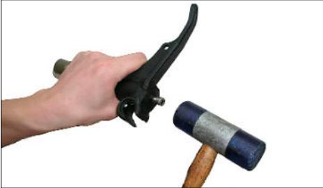
*Durch Hammerschläge auf die Schraube wird die Kolbenstange im Radträger aus ihrer Aufnahme gelöst.*
