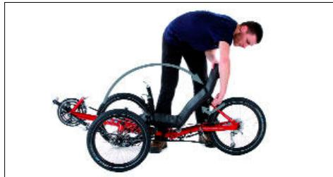
8. Wenn Sie den Ausleger für das Falten nach links gedreht haben, richten Sie ihn wieder gerade aus und schließen die Schnellspannhebel der Tretlagerauslegerklemmung. Beachten Sie die Hinweise zu Schnellspannern auf Seite 13.
