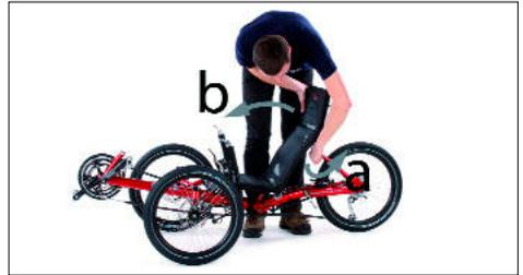
2. Zur Sicherung der Rückenlehne Klettgurt vom zweiten Spannriemen abziehen und auf das Klettband Flausch unter dem Rahmenquerrohr aufkletten.
