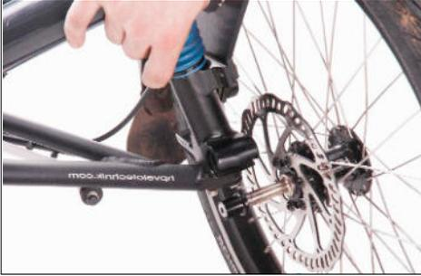
Vorderradausbau: Laufrad aus dem Radträger lösen
