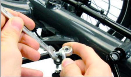
Drehen Sie den Gelenkkopf in die Spurstange hinein, um den vorderen Abstand  $b_v$  zwischen den Vorderrädern zu vergrößern, drehen Sie den Gelenkkopf hinaus, um den Abstand zu verkleinern.
