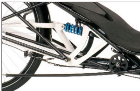
*Kettenleitrolle, Kettenfangwinkel und Kettenschutzrohre am Scorpion fs26*
