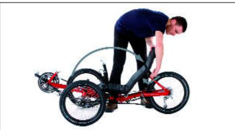
**Gefahr!** Ein nicht geschlossener Schnellspanner kann zur Beschädigung des Rahmens führen. Der Schnellspanner der Sitzlehne muss immer fest geschlossen sein, da der Sitz tragendes Teil des Dreiradrahmens ist. Bitte beachten Sie die Hinweise zur Bedienung von Schnellspannern auf Seite 13.
