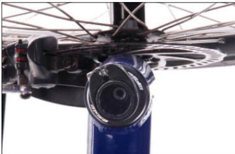
Steuerkopflager mit Kralle im Inneren des Steuerrohrs
