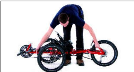
5. Nun den *D.F.F.-Move* vollführen: Rahmen anheben und seitlich drehen, dabei in einer eleganten Bewegung das Hinterrad quer unter den Rahmen falten. Dabei sicherstellen, dass der Anschlagpuffer am Rahmenhinterteil durch das Langloch im Vorbaublech geführt wird, um die Lenkung zu blockieren. Der Puffer darf nicht auf dem Vorbaublech aufschlagen, da dieses sonst verbiegen kann.
