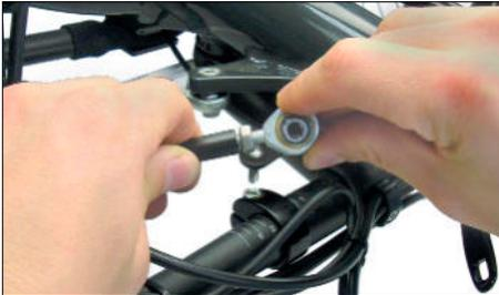
**Achtung!** Schwenken Sie den Gelenkkopf nicht weiter als der normale leichtgängige Schwenkbereich, sonst kann der Gelenkkopf zerstört werden oder übermäßiges Spiel entwickeln. Halten Sie den Gelenkkopf immer mit einem Gabelschlüssel beim Verkontern oder sichern Sie die Spurstange mit einer Zange gegen Verdrehen.
