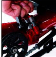
6. Rückenlehne hochklappen und mit dem Schnellspannhebel in der gewünschten Neigung befestigen.
