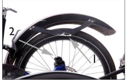
Madenschraube (1) und Klemmschlitz (2) bei der Schutzblechmontage
