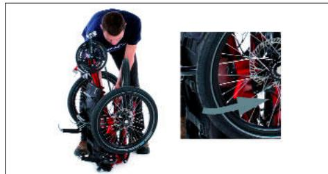
2. Mit der rechten Hand das Hauptrahmenrohr bzw. den Ausleger direkt über der Sitzlehne umgreifen (Knöchel zeigen vom Rad weg).
