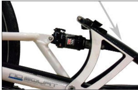
*Die Einstellung der Dämpfung erfolgt über das rote Rad am hinteren Ende. Das Luftfeder-element wird je nach Modell so eingebaut, dass der Kipphebel zur Blockierung am hinteren Ende hinten nach oben (Scorpion Ifs26 Ifs26 Enduro Ifs26 S-Pedelec) bzw. vorne nach unten (Scorpion fx Ifs20) zeigt.*
