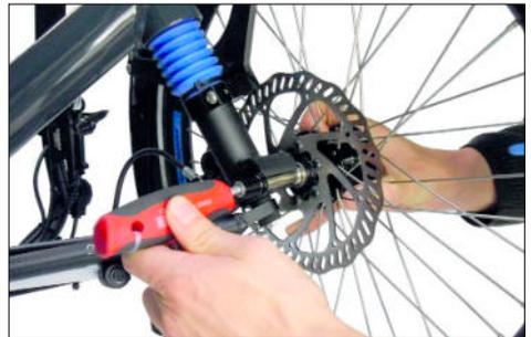
Vorderradausbau: Lösen der Schraube im Endstück
