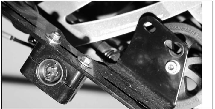
Am Akkuadapter montierte Rosenberger-Buchse
