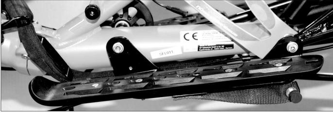
Am Akkuadapter montierte Akkuschiene, hier an der linken Seite.
