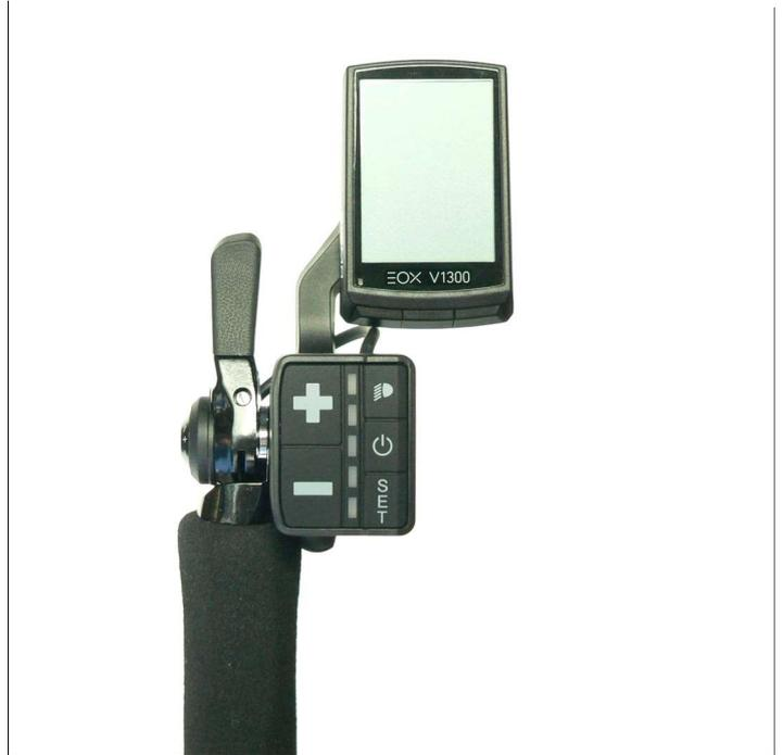
Anbau von Bedieneinheit und Display am Lenkerendschalthebel
