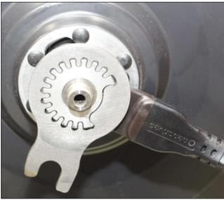
Setzen Sie die Drehmomentstütze auf den Vielzahn.
