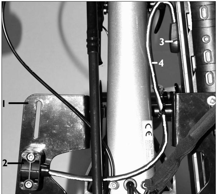
Kabelverlegung zwischen Rosenberger-Buchse und auf der linken Seite montiertem Akku von der Fahrrad-Unterseite aus gesehen.
