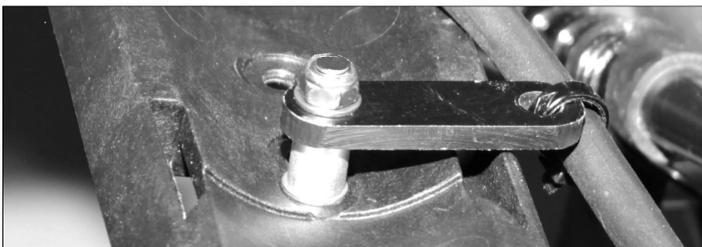
Halteblech für Akkukabel von der Unterseite aus gesehen
