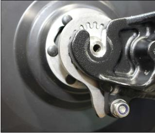
Setzen Sie das Hinterrad so in die Ausfallenden, dass die Drehmomentstütze in die Stützschaube eingreift.
