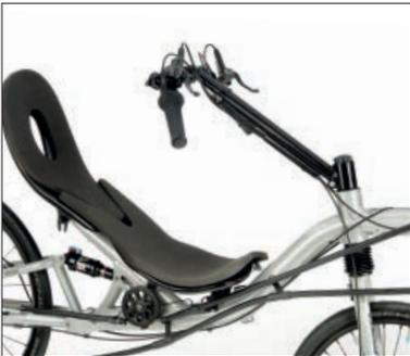
Den *Deichsellenker* bieten wir an für *Speedmaschine* und *Grasshopper fx*. Er kombiniert eine entspannte Armhaltung mit einer guten Aerodynamik. Vorteil beim Transport: Der *Deichsellenker* baut erheblich schmäler als der *Aerolenker*. Zusätzlicher Vorteil auf dem *Grasshopper*: Da können Sie den *Deichsellenker* zum Einsteigen locker nach vorne klappen.
