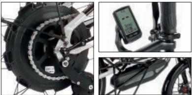
Der optionale elektrische Hilfsantrieb von NEODRIVES unterstützt Sie bis 25 km/h aus dem flüsterleisen Hinterrad-Nabenmotor: 5 Unterstützungsstufen, 40 Nm Spitzendrehmoment. Reichweite bis 136 km. Bergab können Sie per Rekuperation dem leichten Li-Ionen-Akku (576 Wh / 36 V) Energie zurück geben. Anfahrhilfe auf Knopfdruck bis 4 km/h.
