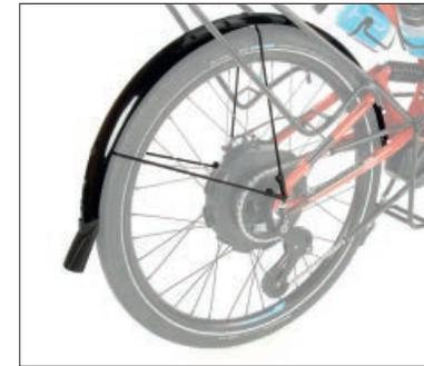
Funktionale Schutzbleche: Die mit einem Abweiser versehenen Schutzbleche von SKS sind weit heruntergezogen und schützen mit ihrer Breite von 55 Millimetern auch bei fetten Reifen gut vor Spritzwasser. Die aus robustem Kunststoff gefertigten Schützer ruhen auf einer formschönen, innen liegenden Befestigung, die sich elegant ins Rahmendesign schmiegt.
