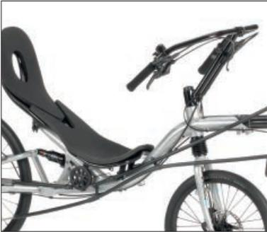
Ob Sie einen *Obenlenker* als *Aerolenker* oder *Deichsellenker* (Bild Mitte) wählen oder sich einen *Untenlenker* wünschen: Letztlich ist das eine Frage der Ergonomie und wie man sich am wohlsten fühlt. Der *Aerolenker* sorgt für eine sportliche, gestreckte Armhaltung und optimale Aerodynamik. Tourenfahrern bietet er zudem reichlich Platz, damit sie ihr digitales Equipment direkt im Sichtfeld unterbringen können.
