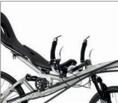
*Untenlenker* gelten als die komfortablere Variante: Einfach locker die Arme baumeln lassen und locker aus der Hüfte lenken. Allerdings ist der *Untenlenker* nicht mit allen Optionen unseres Baukastensystems kompatibel: An *Grasshopper fx* oder *Speedmaschine* schließt ein *Untenlenker* die Kombination mit *ErgoMesh XL-Sitz* ebenso aus wie einen Motor. Für den bequemen *ErgoMesh XL-Sitz* auf der *Streetmaschine Gte* bieten wir als Sonderbauform den *Breiten Untenlenker* an.
