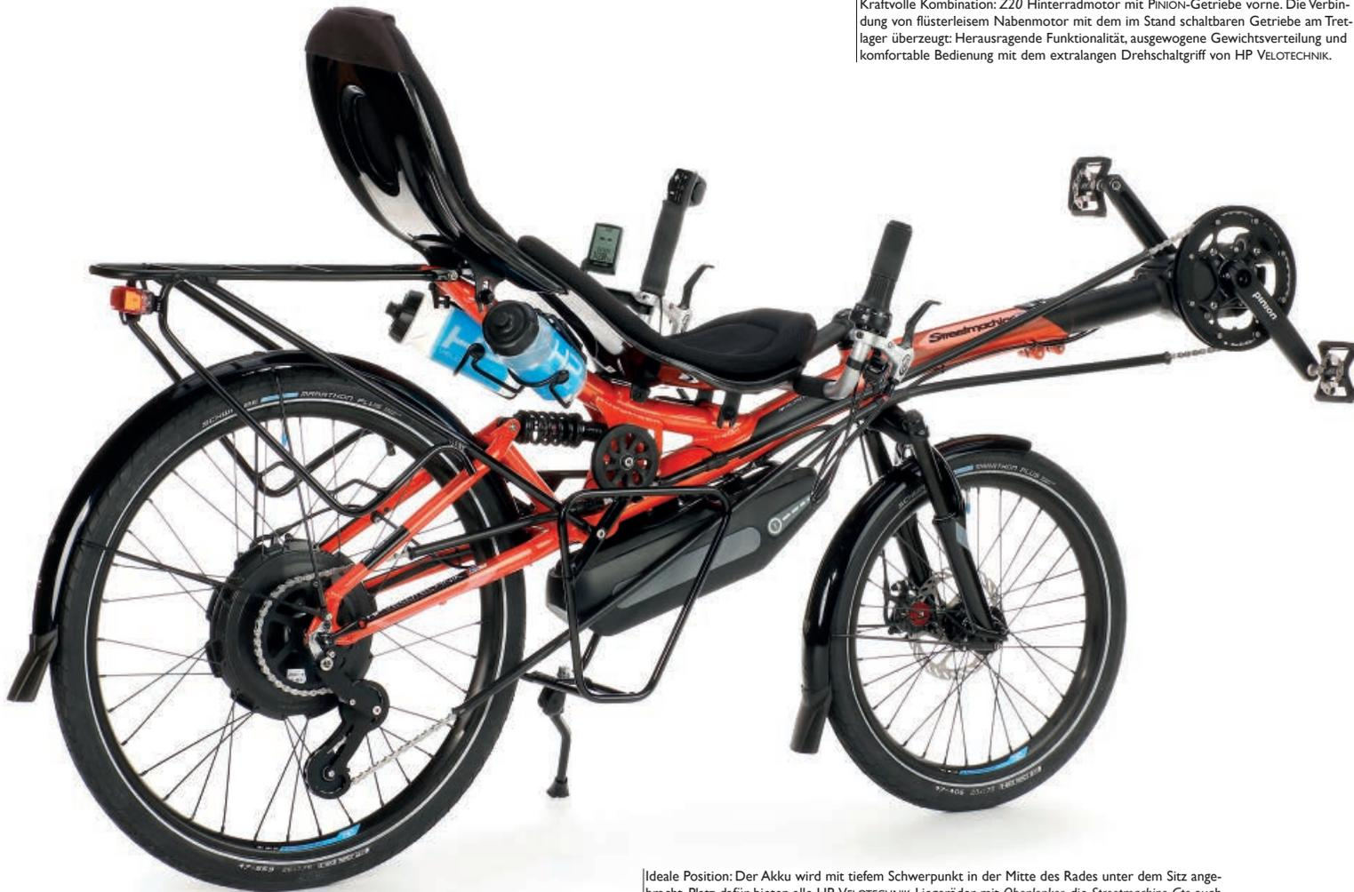
Ideale Position: Der Akku wird mit tiefem Schwerpunkt in der Mitte des Rades unter dem Sitz angebracht. Platz dafür bieten alle HP VELOTECHNIK Liegeräder mit *Obenlenker*, die *Streetmachine Gte* auch mit *Untenlenker*. Zum Laden kann der abschließbare Akku einfach abgenommen werden.
