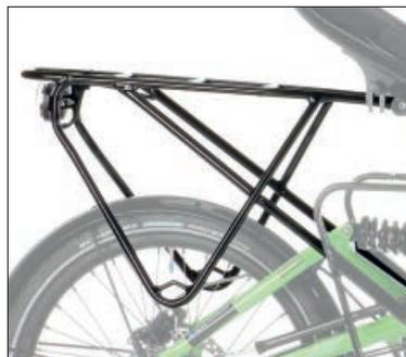
Für alle drei Zweiradmodelle bauen wir speziell geformte Träger aus hochwertigem Alu-Rohr mit 2 mm starken Wänden und einem Durchmesser von 12 mm. So fährt Ihr Gepäck voll gefedert, was ein optimales Federverhalten ermöglicht und gleichzeitig das Material schont. Die Konstruktion bietet reichlich Platz für Ihre Ausrüstung und gibt den Packtaschen mit den Seitenbügeln sicheren Halt. Sinnvoll integriert: Ein Schutzbügel für Ihr Rücklicht und ein Wimpelhalter.
