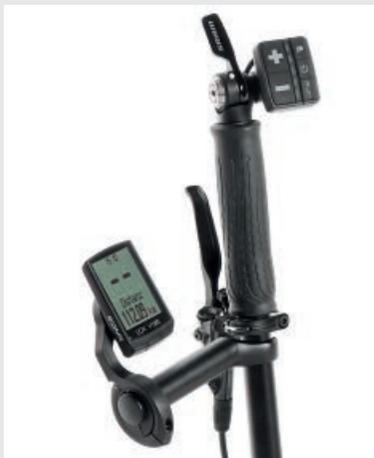
**Eine Frage der Positionierung:** Die Platzierung des Displays an Ihrem Pedelec hängt von der Wahl des Lenkers ab. Den *Obenlenker* bieten wir für alle einspurigen Modelle an. Auf dem ist das Display mittig in der Nähe des Vorbaus montiert.
