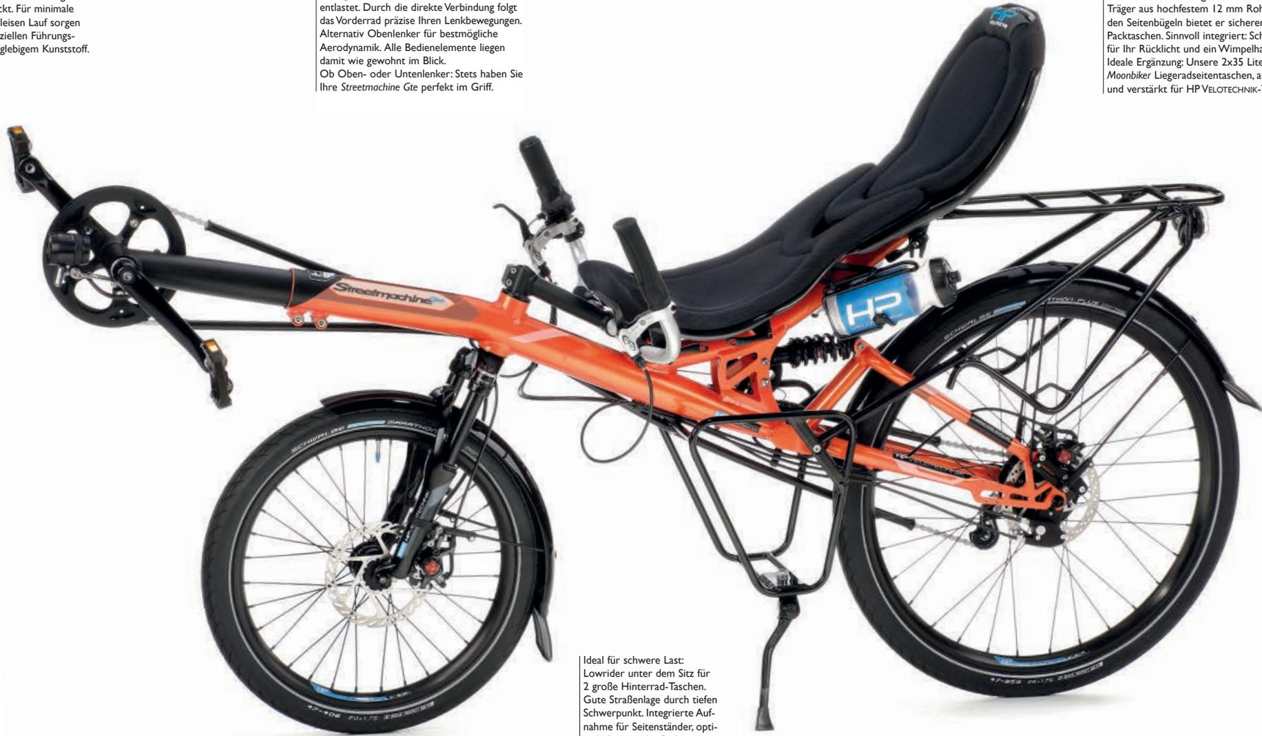
Hochwertige TSR AX1 Federgabel mit einstellbarer Federvorspannung und austauschbaren Stahlfedern. Die serienmäßigen Scheibenbremsen sorgen für zuverlässig hohe Bremskraft selbst auf langen Bergabfahrten oder bei Nässe und schonen die Felgen vor Verschleiß.
