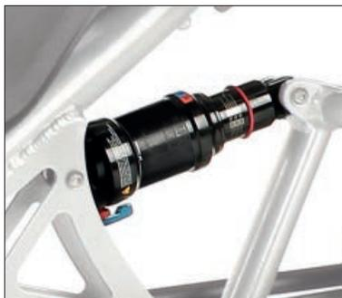
Luftfeder-element *Monarch RL* von ROCK SHOX. Praktisch: Per mitgelieferter Pumpe kann die Federhärte an die Zuladung angepasst werden. Mit einer einstellbaren hydraulischen Zugstufendämpfung und blockierbarer Druckstufe ausgestattet, überzeugt der Dämpfer mit hervorragendem Ansprechverhalten in unseren Tests. 262 g Gewichtsersparnis gegenüber dem Stahlfeder-element DNM DV-22.
