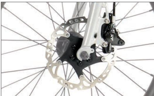
Daran führt kein Weg vorbei: Die Bremse ist eine Scheibe. Alle Zweirad-Modelle von HP VELOTECHNIK sind mit Scheibenbremsen ausgestattet. Prunkstück ist die hydraulische SHIMANO XT, wahlweise kommt aber auch die mechanische BB7 von AVID zum Einsatz.
