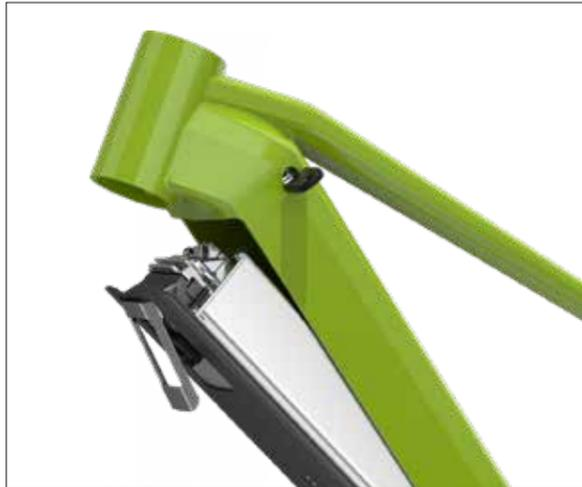
Insertion de la batterie semi-intégrée UR V8
