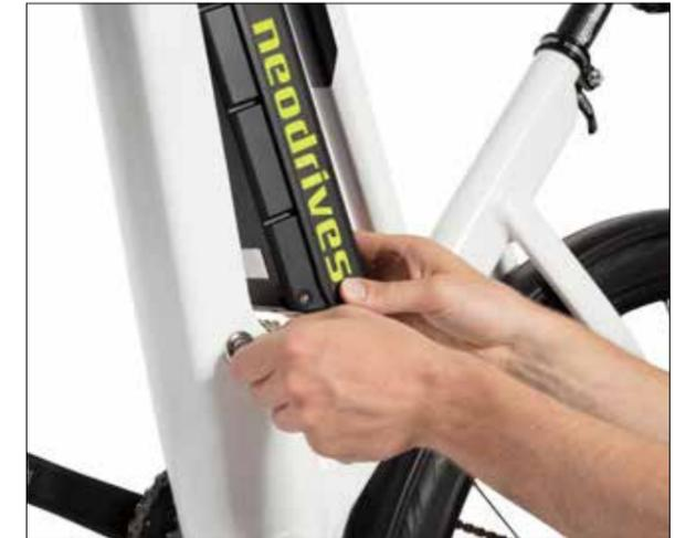
Insertion de la batterie semi-intégrée UR V7
