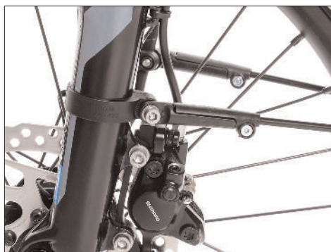
Befestigung an der Gabel mittels Schelle, möglich bei Streetmaschine, Speedmaschine und Grasshopper
