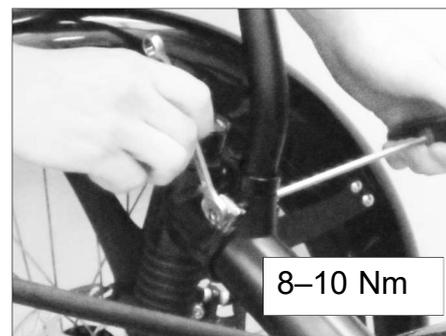
Richten Sie die Aufstehhilfe aus und fixieren Sie sie in der gewünschten Position indem Sie den Schnellspanner schließen. Hinweise zu Schnellspannern finden Sie in der Originalbetriebsanleitung Ihres Dreirads.
