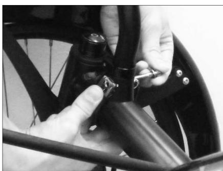
Nutzen Sie zur Befestigung des Adapters zunächst die längere Zylinderkopfschraube (45 mm) um die Gelenkbolzenschelle vorzuformen. Danach tauschen Sie die Schraube gegen die kürzere Zylinderkopfschraube (40 mm), legen Sie dabei eine Unterlegscheibe unter den Schraubenkopf. Ziehen Sie die Schraube mit einem Drehmoment von 8–10 Nm fest.
