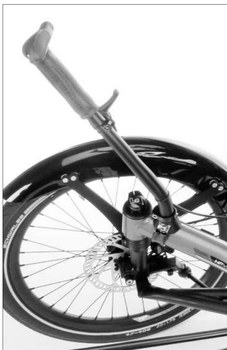
Aufstehhilfe montiert an einem Scorpion plus 20
