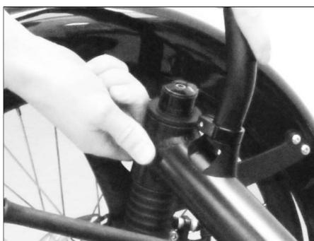
Legen Sie die Gelenkbolzenschelle um das Querrohr.
