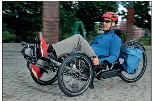
Mit Motor ganz vorne: Der neue E-Antrieb Steps mit Automatikschaltung Di2 ist elegant integriert ins Line-up des Komfort-Trikes Scorpion plus 26. Aber auch im neuen Speed-Dreirad aus Kriftel, dem Scorpion, leistet die Tretunterstützung von SHIMANO hervorragende Dienste. Bilder: HP Velotechnik
