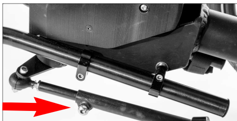
Klemmschraube zum Einstellen der Schubstangenlänge
