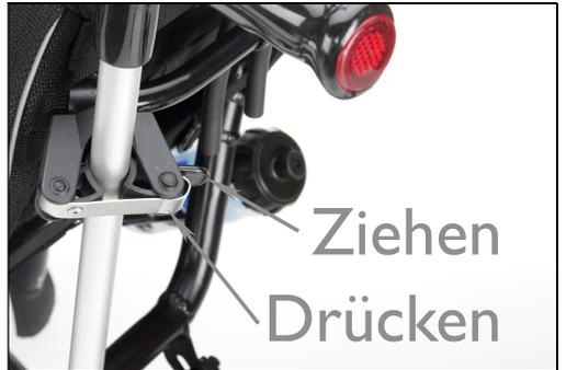
**Hinweis:** Je nach Montageseite des Gehilfenhalters kann es nötig sein, den Köcher zum Falten des Fahrrads zu verdrehen, damit dieser nicht mit dem Rahmen oder anderen Fahrradteilen kollidiert
