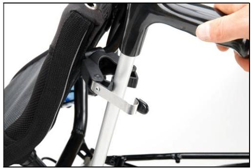
Zum entnehmen der Gehhilfe lösen Sie die Sicherung, indem sie an der schwarzen Lasche des Sicherungsbleches ziehen, jedoch nur soweit, das es gerade eben nicht mehr eingerastet ist. Sie können nun die Gehhilfe fassen und aus der Halterung ziehen, die sich dabei von selbst vollständig öffnet.
