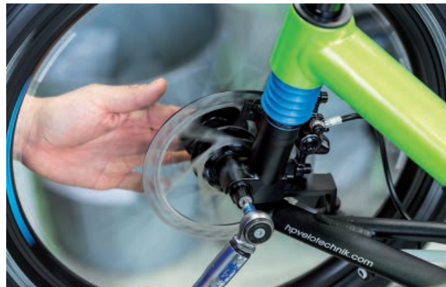
Ein Vorderrad findet seinen Platz am hochfest geschmiedeten Radträger des Scorpionfs Enduro-Fahrwerks. An diesem Modell schützt ein blauer Faltenbalg das Federbein.
