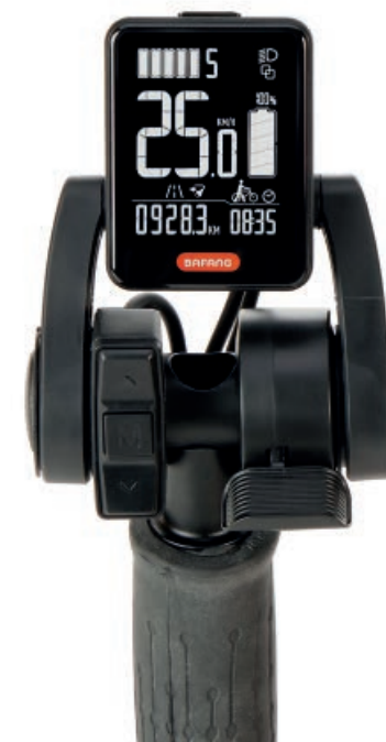
Rechts unterhalb des sehr übersichtlichen Displays der Throttle genannte Daumenhebel, links die Tipptasten, um die Unterstützungsstufe zu wechseln oder die Tachoinformationen durchzuschalten.
