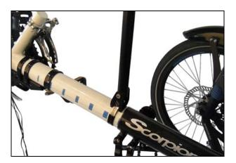
Befestigen Sie den Halter für Scheinwerfer und Positionslicht g unter der Verschraubung des vorderen Haltebogens h (ca. 50cm breit, Verschlusstopfen im Rohr).
