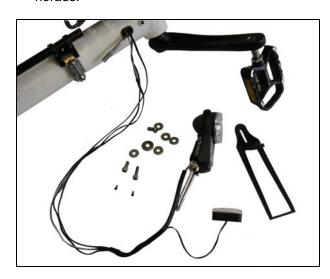
Stecken Sie die Kabelverlängerung am Steckkontakt des Lichtkabels, der aus dem Rahmen herausschaut, an.
