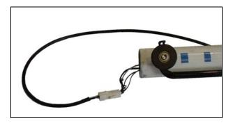
Ziehen Sie das Lichtkabel auf der Innenlagerseite vorsichtig etwa 40cm aus dem Ausleger heraus.
