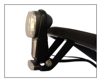
Kabelverlegung: Das Kabel des Positionslicht soll nach unten herauskommen und dann oberhalb einer der Kunststoffdistanzhülsen zum Scheinwerferkabel verlaufen.
