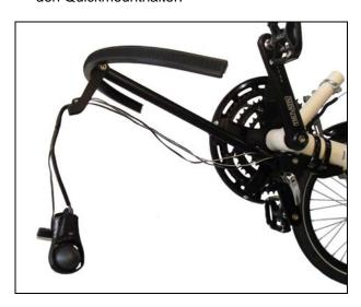
Schieben Sie den hinteren Haltebogen **k** (ca. 52cm breit) in das Teleskoprohr **d** und befestigen Sie ihn durch drehen der Rändelmutter **i**.
