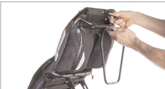
5. Schrauben Sie die zugehörigen Schrauben lose in die Klemmschelle ein.
