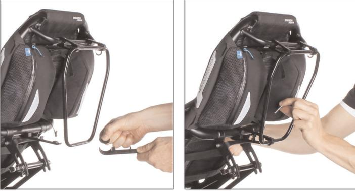
11. Schrauben Sie die zugehörigen Schrauben lose in die Klemmschelle ein.
