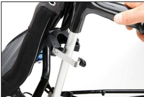
Die Gehhilfe hält nun bereits in der Halterung. Das Sicherungsblech klappt selbsttätig vor. Drücken Sie es über das Gummiteil, so dass es über den äußeren Teil der Halterung rutscht und fühlbar "einrastet". Nur dann ist die Gehhilfe gegen unbeabsichtigtes Herausfallen gesichert.
