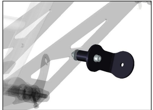
Das Köcheradapterblech wird beim Delta tx am Sitzadapterblech montiert.
