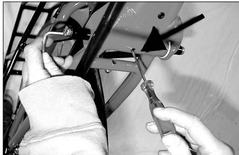
Auf der Unterseite der Hinterradschwinge befindet sich eine Bohrung. Mit einem dünnen Schraubendreher oder einem Metallstift kann die Achse gegen Verdrehen gesichert werden.
