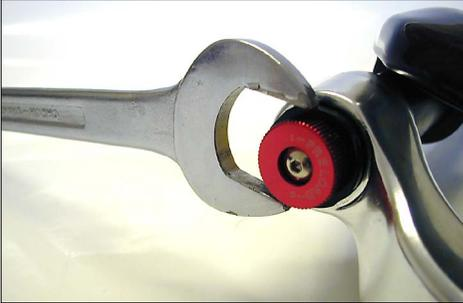
*Nach dem Entspannen der Feder-Vorspannungseinheit kann die ganze Einheit herausgedreht werden.*
