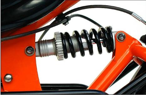
Federelement DNM DV-22 Durch das Drehen des Einstellringes am vorderen Ende der Feder stellen Sie die Federvorspannung ein.
