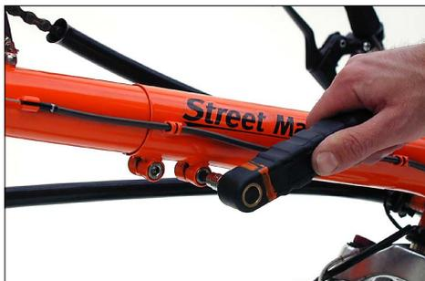
Lösen der Klemmschrauben zum Verstellen des Tretlagerauslegers.
