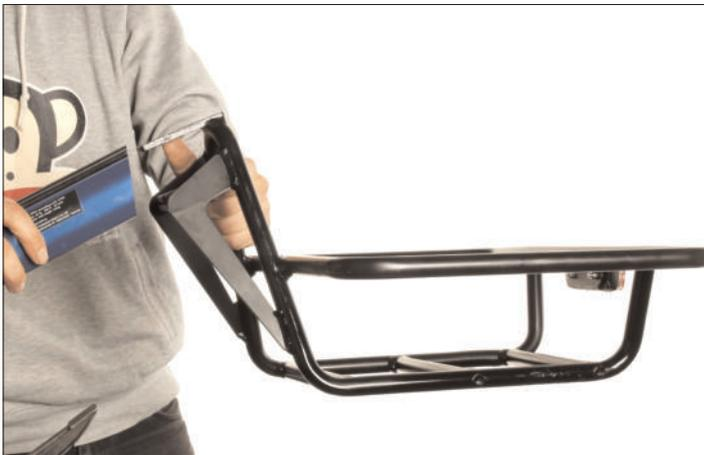
15. Bringen Sie das hintere Hauptrahmenrohr in eine waagerechte Position.
