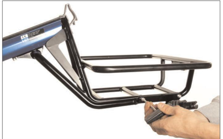
23. Ziehen Sie alle Verschraubungen des Versteifungsarmes mit 7–9 Nm fest.
