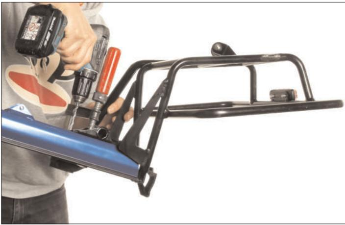
13. Demontieren Sie den Versteifungsarm vom Gepäckträger.
