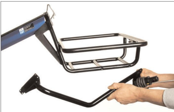
6. Verschrauben Sie den Versteifungsarm an der hinteren Bohrung mit dem Gepäckträger. Wenn keine Kippschutzrollen montiert sind, nutzen Sie eine M6x20 Schraube mit Scheibe. Sind Kippschutzrollen montiert, nutzen Sie die beiden ebenfalls beiliegende M6x30 Schraube mit Scheibe. Schrauben Sie den Versteifungsarm durch das Halteblech der Kippschutzrollen und die Sattelscheiben im Gepäckträger fest. Drehen Sie die Schraube vollständig ein, aber ziehen Sie sie nicht fest.
