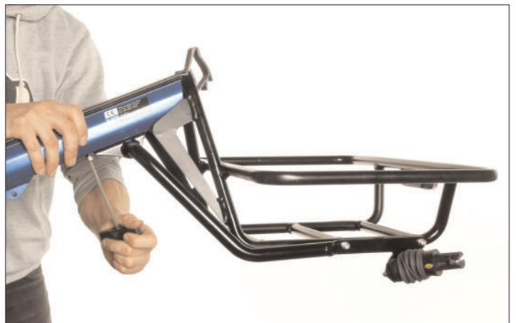
24. Ziehen Sie die Schwinge nach oben und verschrauben Sie das Federelement wieder im Rahmen (mit 6 – 8 Nm).
