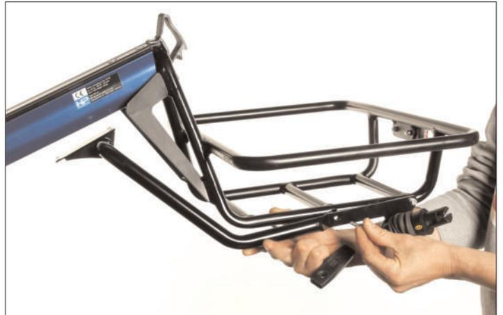
7. Verschrauben Sie den Versteifungsarm auch an der vorderen Bohrung mit dem Gepäckträger. Schrauben Sie die Schraube vollständig ein, aber ziehen Sie sie nicht fest.
