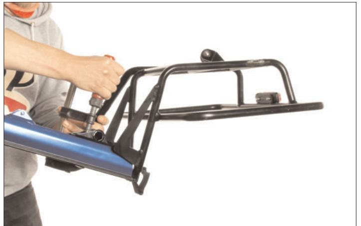
11. Bohren Sie die 4 Löcher des Bleches mit einem 6,5mm Bohrer durch den Rahmen.
