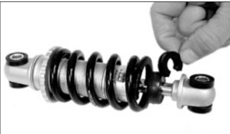
*Durch das Aufstecken von Distanzclips auf die Kolbenstange des Federelementes wird der Federweg begrenzt.*
