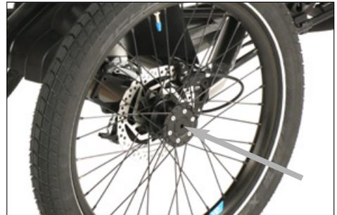
Zentrale Befestigungsschraube der Hinterradnabe
