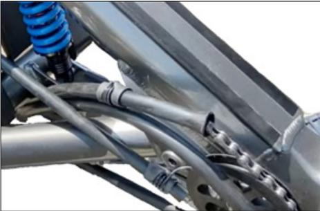
Die Kette wird zwischen die Schwingenrohre geschoben.
