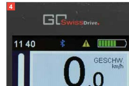
Die aktuell ausgewählte **Unterstützungsstufe** wird durch die Grafik am linken Display-Rand visualisiert (1). Mittels der +/-Tasten können Sie zwischen fünf positiven Unterstützungsstufen und zwei Rekuperationsstufen wählen. Wird die Unterstützungsstufe 0 gewählt, unterstützt der Motor nicht mehr. Durch Drücken der +Taste erhöhen Sie die Unterstützungsstufe, durch Drücken der –Taste verringern Sie die Unterstützungsstufe.
