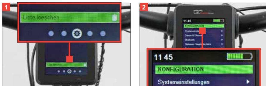
Die aktuell markierte Schaltfläche wird grün hervorgehoben (3). Aus einem Untermenü gelangen Sie zurück ins Hauptmenü, indem Sie zur Schaltfläche „Konfiguration“ am Kopf des Untermenüs navigieren – diese ist dann grün hervorgehoben – und dann die Bestätigen Taste des Nahbedienteils drücken.
