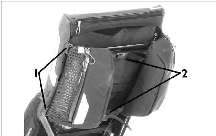
Abb. 1: Anbringen der Add-on bags: 1 - Befestigungsschnallen am Sitz, 2 - Steckverschlüsse
