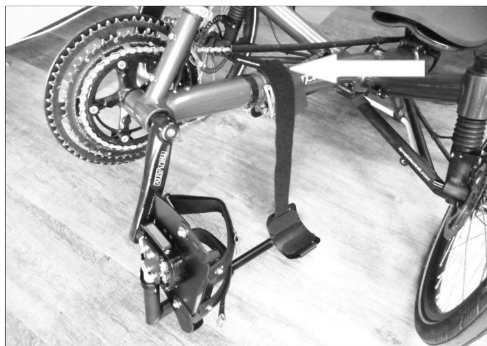
Abb. 7: Positionierung des Klettstreifens als Halterung für die Unterschenkelfixierung
