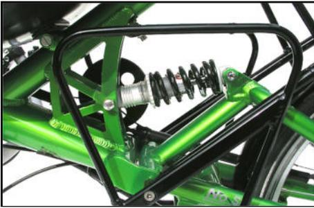
Federelement mit Stahlfeder. Durch Drehen des Einstellringes am vom vorderen Ende der Stahlfeder stellen Sie die Federvorspannung ein
