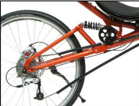
*Kettenleitrolle, Kettenfangwinkel und Kettenschutzrohre an der Streetmachine Gte.*
