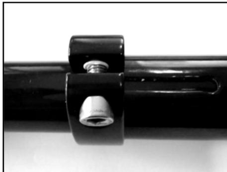
*Klemmung der Höhenverstellung am Obenlenkervorbau. Beim Blick auf den Klemmschlitz darf das Rohrende der oberen Vorbauhälfte nicht sichtbar sein*
