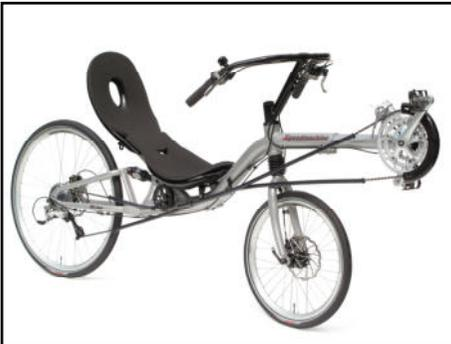
*Aerolenker bei der Speedmaschine*
