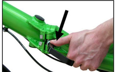
*Nach dem Öffnen des Schnellspanners am Falgelenk muss der Schnellspanner nach unten gedrückt werden, damit der Sicherungsbolzen ausgelöst werden kann*
