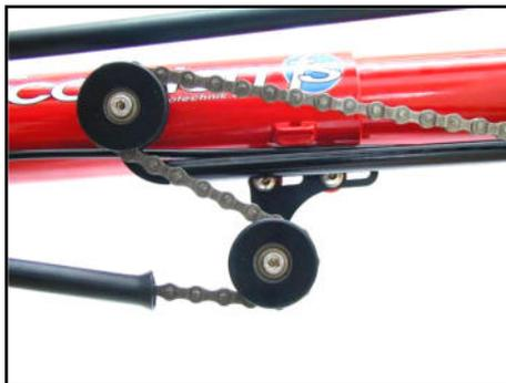
Verlauf der Kette bei Rahmenschnellverstellung über die Umlenkrollen
