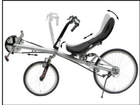
Verstellmöglichkeiten bei BodyLink-Sitzen (Streetmaschine Gte, Ausführung mit Deichsellenker)
