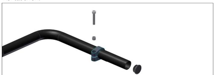
Abb. 6: Montage von Klemmschelle und Lenkerendstopfen
