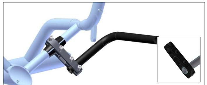
Abb. 4: Montage von Stützhülse, Klemme und Halterrohr. Blick von schräg hinten auf die rechte Sitzstrebe, das Halterrohr zeigt zum Hinterrad.
