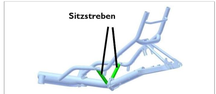
Abb. 3: Die Side Bag Mounts werden an die Sitzstreben montiert.
