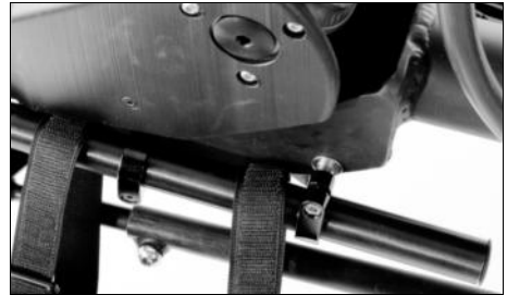
Abb. 8: Das Beinnetz ist vor den Klemmschellen angebracht.
