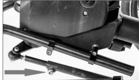
Abb. 3: Klemmschraube zum Einstellen der Schubstangenlänge
