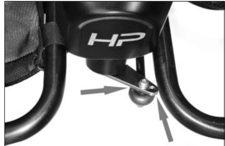
Abb. 12: Zur Befestigung der Schubstange und Einstellung der Lenkung stehen 2 Gewinde am Lenkhebel zur Auswahl.
