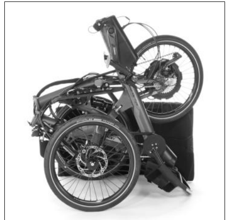
Abb. 2: Gefaltetes Scorpion fs 20 mit Handantrieb Hands-On-Cycle. Der Sitz wurde abgenommen.
