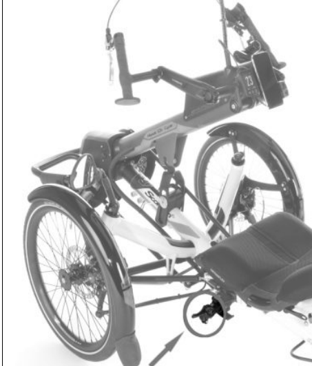
Abb. 1: Parkbremse: Ziehen Sie den Hebel nach vorn zum Feststellen der Parkbremse. Drücken Sie den Hebel zurück zum Lösen der Parkbremse.
