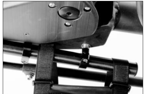
Abb. 9: Das Beinnetz ist hinter den Klemmschellen angebracht.
