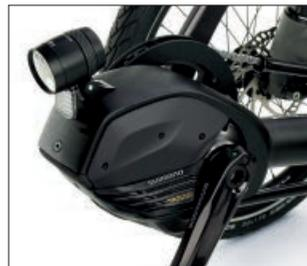
**Das Flaggschiff:** Mit dem *EP801* hat SHIMANO das Thema E-Mobilität in eine neue Dimension katapultiert. Sämtliche Module wurden überarbeitet und mit einer neuen Software ausgestattet. Das Toppystem überzeugt mit einem Drehmoment von 85 Newtonmetern. Dass bei HP VELOTECHNIK ein großes Farbdisplay (7,1 cm) mit zahlreichen Fahrradcomputerfunktionen dazu gehört, ist selbstverständlich.
