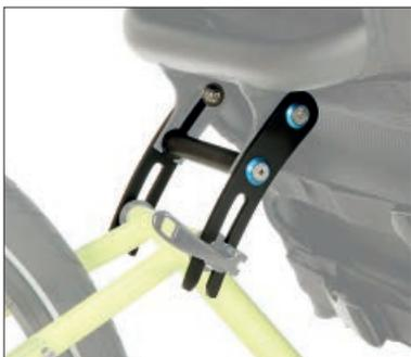
**Steiles Teil:** Mit dem **Sitzwinkeladapter** stellen Sie den Sitz um 9° steiler, können aber weiterhin die Neigung variieren (48° – 56°). Passend für die Modelle **Gekko fx 20**, **Gekko fx 26** und **Gekko 26**.
