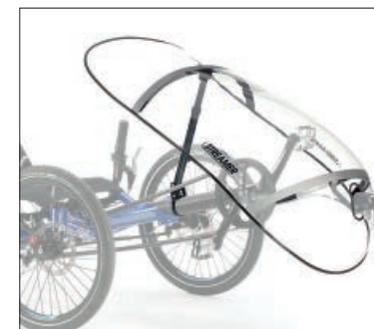
Schutz vor Wind und Wetter: Die Frontverkleidung *Streamer* von HP VELOTECHNIK hält Ihre Füße warm und Ihre Beine trocken. Neigung und Höhe sind verstellbar. Der Wetterschutz ist einfach per Schnellspanner abnehmbar und kann zum Transport aufgerollt werden. Tropfenform für geringen Windwiderstand. Gewicht ca. 2,2 kg. Transparenter, bruchfester Kunststoff.
