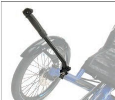
Mit der *Aufstehhilfe* erhalten Sie zwei Handgriffe, die jeweils links und rechts über den Vorderrädern montiert werden. Diese bieten Ihnen festen Halt, um sich aus dem Sitz hoch zu ziehen oder um sich beim Einsteigen abzustützen. Die Handgriffe können dank Schnellspannern ganz einfach eingestellt oder, zum Falten des Rades, abgenommen werden.
