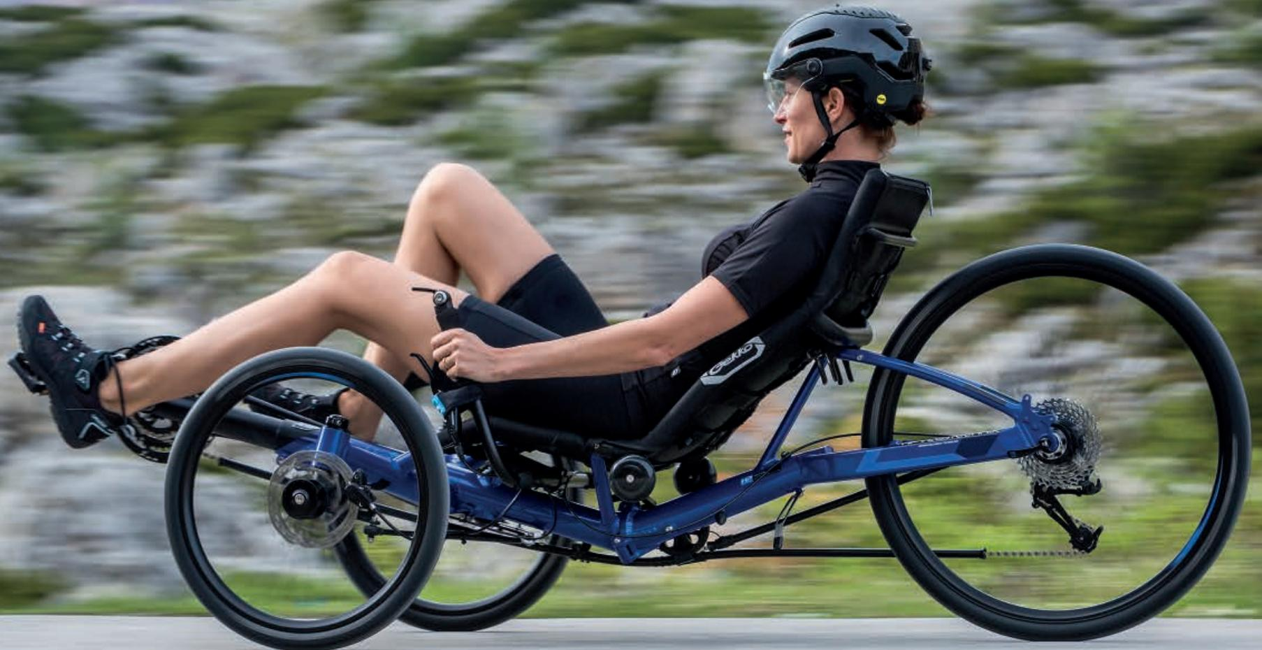
**Elegantes Wachstum für die Gekko-Klasse:** Beim Gekko fx 26 bringt das große 26 Zoll-Hinterrad dynamischen Vortrieb. Die Vorteile sind klar: Das mächtige Triebwerk hinter dem Cockpit sorgt für ein spürbar komfortableres Fahrverhalten. Stichworte dafür sind mehr Laufruhe, geringerer Rollwiderstand und leichteres Überrollen von Hindernissen.
