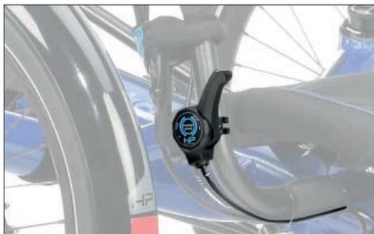
Was im Auto die Handbremse leistet, besorgt am Dreirad die *Parkbremse* (Bild links): sicheres Abstellen auch bei abschüssigem Untergrund. SHIMANO V-Brake mit großem Daumenrasthebel.
