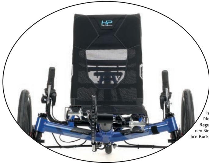
Der anatomisch geformte Sitz ist mit einem luftdurchlässigen Netzgewebe bespannt. Durch die Regulierung der Spanngurte können Sie die Sitzform individuell an Ihre Rückenform anpassen.
