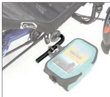
An den universell einsetzbaren Seitentaschenhalter *Side Bag Mount* passen kleine Gepäckbehälter wie auch eine Vielzahl verschiedenster Anbauteile (bis 5 kg Zuladung). Das reicht von wasserdichten Lenkertaschen wie denen von ORTLIEB bis zum Halter fürs Getränk. Das schwarz eloxierte Alu-Rohr (22 mm Durchmesser) lässt sich in unterschiedlichen Positionen anbringen. Bei montiertem *Side Bag Mount* ist Ziehfunktion auf Rollen am Sitz nicht möglich.
