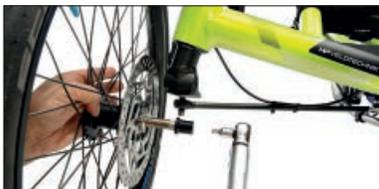
Um Ihren Gekko 26 noch kleiner zu machen, benötigen Sie lediglich einen Inbusschlüssel. Lösen Sie mit diesem die Achsschraube der HP Performance Nabe und Sie können das Vorderrad einfach mitsamt der Brems Scheibe abnehmen.
