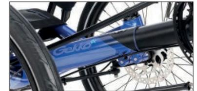
Der Rahmen wird auf Ihre Beinlänge nach dem Lösen der beiden Klemmschrauben auf der Rahmenunterseite durch teleskopisches Einschleiben oder Ausziehen des Tretlagerauslegers aus dem Hauptrahmen eingestellt.
