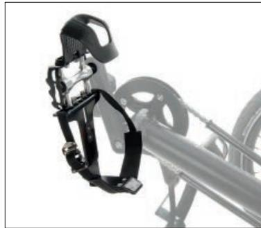
*Pedal mit Fersenfixierung*: Das alternative Pedal für alle, die kein SPD-Systempedal nutzen wollen oder können. Einfacher, schneller Einstieg mit dem Schuh durch die ausgependelte Ruheposition. Mit Einhand-Fixierung der Ferse für sicheres und effizientes Pedalieren. Zum Ausstieg wird der Schuh auf Wunsch mit Druck auf den Fersenhaken sofort wieder freigegeben.
