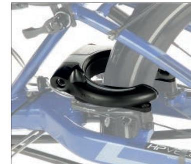
Wegfahrsperr: Bügel rauschieben, Schlüssel ziehen – und das kräftige *Axa-Rahmenschloss* blockiert wirkungsvoll das Hinterrad. Als Zusatz empfiehlt sich die *Einsteckkette Axa* (1 m lang), um das Trike gleich noch sicher anzuschließen.
