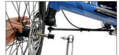
Praktisch beim Transport: HP VELOTECHNIK hat offene Radträger entwickelt. Mit den HP Performance Naben können die Vorderräder mitsamt den Bremsscheiben nach dem Lösen nur einer Schraube einfach abgenommen werden. (Performance Naben sind Serienstandard bei Gekko fx 20, Gekko fx 26 und Gekko fxs).
