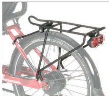
Der stabile *Gepäckträger* für zwei Packtaschen bis 25 kg Last wurde für die hohen Seitenkräfte beim Dreiradfahren optimiert. Ihre Packtaschen hängen schwerkraftgemäß tief unten und nah am Fahrer seitlich neben dem Hinterrad. Vorteil der Gekko-Bauweisen: Gleich integriert ist die Plattform für sperriges Gepäck über dem Hinterrad. Alu-Konstruktion aus hochfestem Rohr mit schwarzer Pulverbeschichtung.
