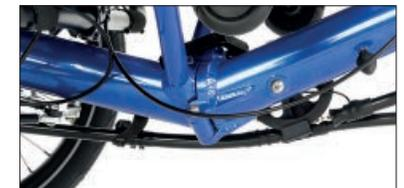
Doppelte Sicherheit: Das robuste Falgelenk verfügt über einen Sicherungsbolzen, der nach dem Lösen des Schnellspanners gegen Federdruck entriegelt wird. Präzisions-Faltachse aus Edelstahl von HP VELOTECHNIK.
