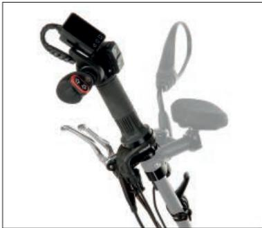
Alles aus einer Hand: Menschen, die alle Bedienelemente an ihrem Rad auf einer Seite des Lenkers benötigen, wählen die Option *Einhandbedienung*: Dank Einzelfertigung in Manufakturbauweise können wir Ihnen Motorsteuerung, Gangschaltung, Bremse plus Parkbremse sowie Licht samt Blinkerschalter links oder rechts montieren.
