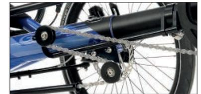
Mit der optionalen Rahmenschnellverstellung kann die Länge noch schneller eingestellt werden. Die Änderung der Kettenlänge wird mit leichtgängigen Umlenkrollen kompensiert. Durch Einschleiben des Tretlagerauslegers wird Ihr Gekko fx 26 damit noch kompakter beim Transport.
