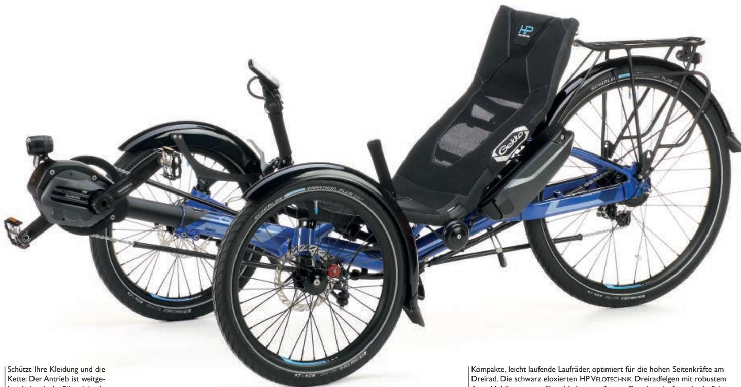
Schützt Ihre Kleidung und die Kette: Der Antrieb ist weitgehend abgedeckt. Für minimale Reibung und leisen Lauf sorgen dabei die speziellen Führungsrohre aus langlebigem Kunststoff.
