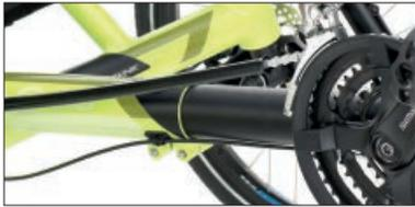
Der Rahmen wird auf Ihre Beinlänge nach dem Lösen der beiden Klemmschrauben auf der Rahmenunterseite durch teleskopisches Einschieben oder Ausziehen des Tretlagerauslegers aus dem Hauptrahmen eingestellt.
