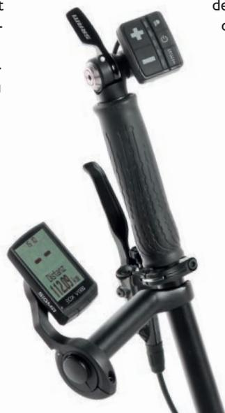
**Einzigartig im Liegeradbereich:** Das Gekko mit Nabenmotor verfügt über einen elektrischen Rückwärtsgang zum Rangieren. Die Rückwärtsfahrt mit bis zu 3 km/h wird über ein Untermenü in der Bedieneinheit aktiviert und mit einer Initialbewegung durch den Fahrer eingeleitet.
