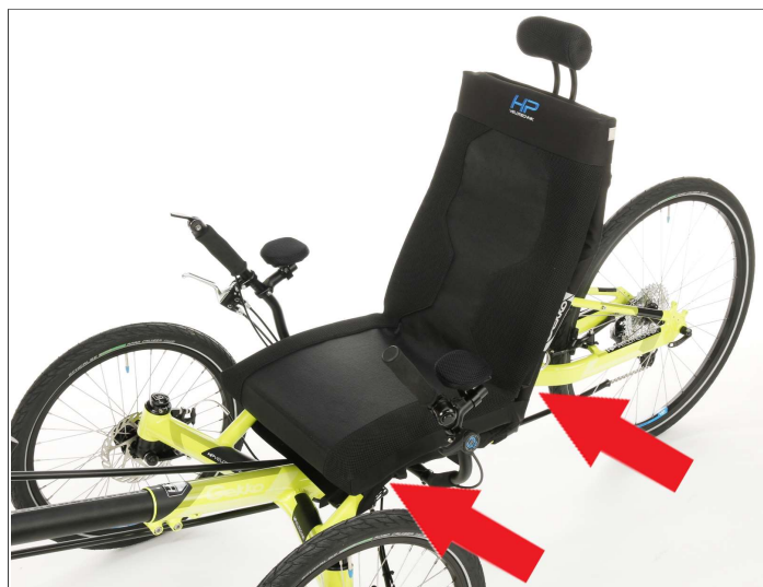
Abb. 2 / Fig. 2: Befestigung an der unteren Rückenlehne und der Sitzfläche. Attachment to the lower backrest and seat
