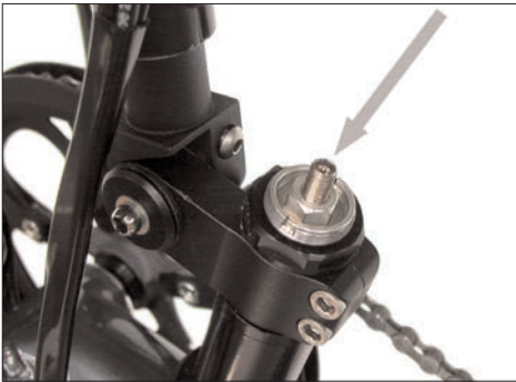
Im Gabelschaftrohr befindet sich das Luftventil zur Anpassung der Federhärte.
