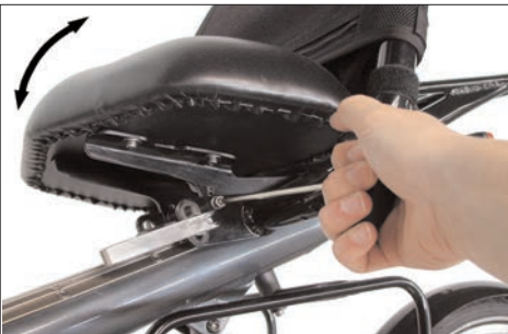
Lösen der Klemmschraube links unter dem Sitzkissen
