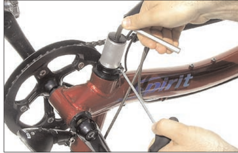
Einstellen des Steuersatzes mit aufgeschobener Einstellhülse
