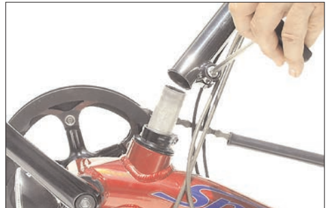
Nach dem Lösen der Vorbaulklemmschraube kann der Vorbau abgezogen werden.
