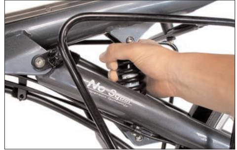
Drehen des Einstellrings zur Regulierung der Federvorspannung.
