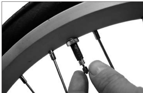
Zum Aufpumpen muss die Sicherungsmutter des Ventils gelöst werden.
