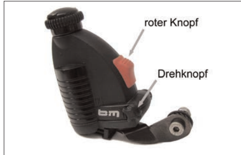
Der Seitendynamo wird durch Drücken auf den roten Knopf eingeschaltet. Zum Ausschalten wird er vom Rad weggeschwenkt.
